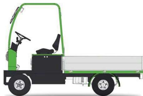
Transportador de 4 ruedas con plataforma. Con dispositivo "hombre presente" y tracción trasera. Extremadamente compacto y fácil de manejar, es ideal para todos los trabajos – tanto bajo techo como al aire libre, incluso para recorrer trayectos largos. El transportador PE15 viene preparado de fábrica para instalar numerosos equipos en la plataforma.
